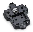
Acople y carque una sola impresora Series ZQ500 en un escritorio o en un vehículo o un montacargas. Debe pedirse con un adaptador para encendedores de vehículos de extremo abierto o un adaptador de CA. Cumple con la clasificación IP43 para mayor protección contra el ingreso de elementos líquidos
